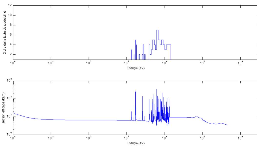
Figure 3.3 Nombre de sous-groupes en fonction de l'énergie pour ZrO
