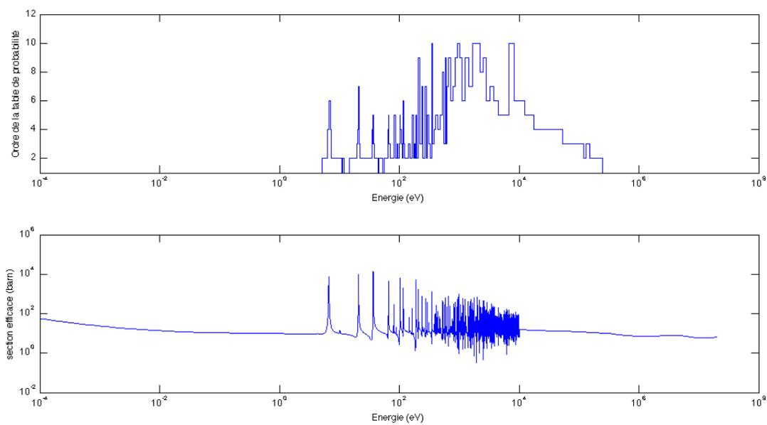
Figure 3.2 Nombre de sous-groupes en fonction de l'énergie pour  $^{238}\text{U}$
